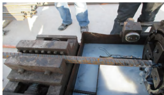
HRB400E \Phi 28 钢筋 (1)、采用复式合格的 HRB400E \Phi 28 钢筋
